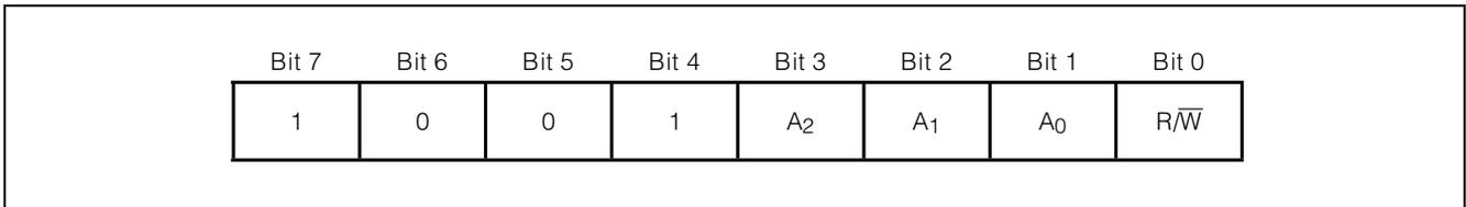
Figure 7. Address Byte
