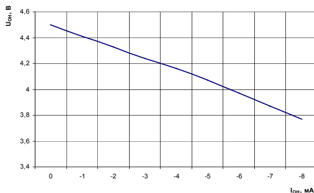
Рисунок 13 Зависимость выходного напряжения высокого уровня от тока нагрузки, при T=25°C
