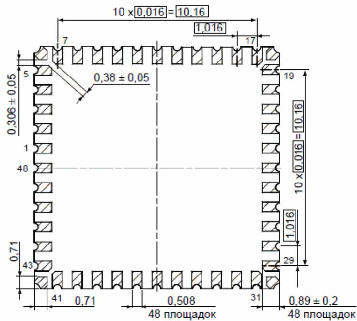
Габаритный чертеж корпуса 5142.48-А
