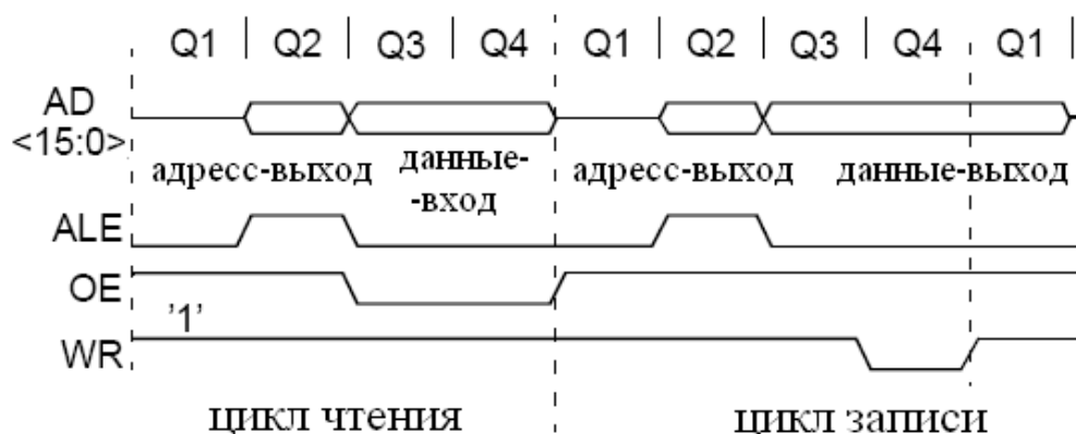
Рис. 14 Диаграммы сигналов доступа к внешней памяти программ
