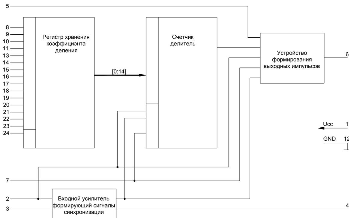
Рисунок 1. Структурная блок-схема
