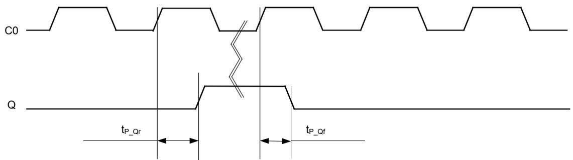
**Рисунок 5** Временная диаграмма при измерении динамического параметра  $t_{PAV\_Q}$
