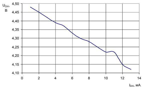
**Рисунок 14** – Зависимость выходного напряжения высокого уровня на выходе Q от тока нагрузки
