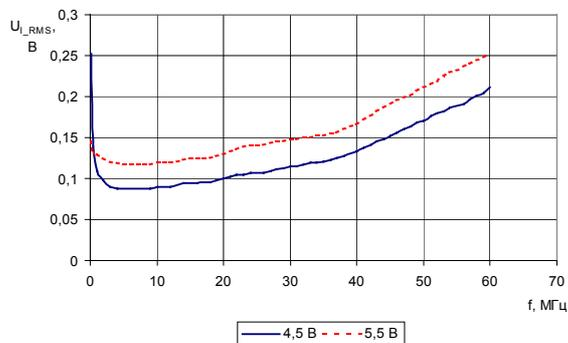
**Рисунок 12** – Зависимость среднеквадратического значения входного напряжения от частоты основного сигнала, при:  $U_{CC}=4,5$  В и  $U_{CC}=5,5$  В (границы области функционирования в режиме усиления аналогового сигнала)
