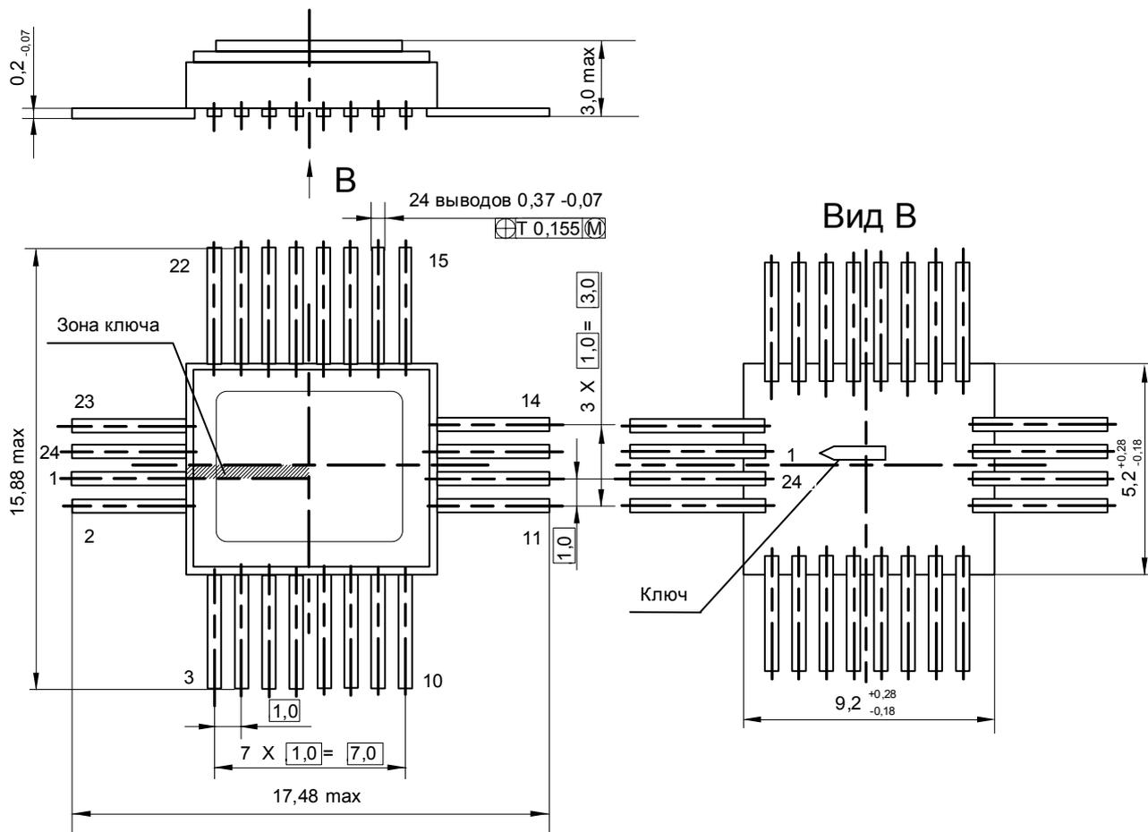
Рисунок 8 Корпус H06.24-1B
