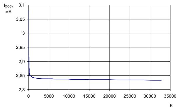
**Рисунок 16** – Зависимость динамического тока потребления от коэффициента деления, при:  $f = 60$  МГц
