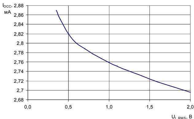
**Рисунок 11** – Зависимость динамического тока потребления от значения среднеквадратического напряжения входного сигнала, при:  $f=60$  МГц и  $U_{CC}=5,5$  В
